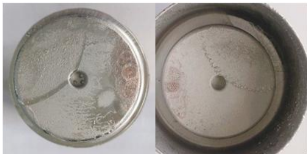
图 6 触头照片(左侧为阴极、右侧为阳极)
